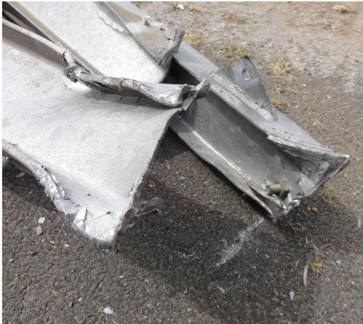
Poutre métallique déformée suite à sa dépose à la pince hydraulique.
